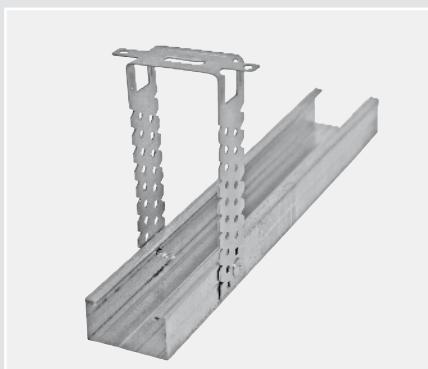
يستخدم الملحق كقوس قابل للتعديل لنظام بطانة الجدار W623 كناوف أو D11 أدوات التعليق لنظام السقف CD كناوف. ويرتبط بقنوات CD كناوف بسامير LN 3,5 . ويمكن قطعها وتقويسها وفق طول التعليق. وقد صممت للاستخدام الخصري مع نظام السقف D11 كناوف ونظام بطانة الجدار W623. (فئة سعة حمل الوزن = 40 كغم)
